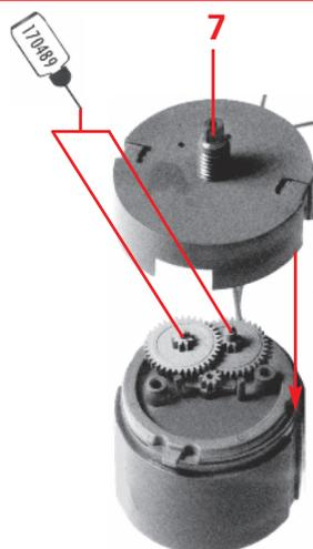
Gehäuse mit 2 Klammern verschließen.
